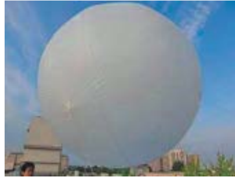
パイロットバルーン
