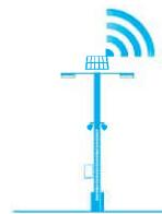
LED街路灯に組み込まれた通信装置がワイヤレスメッシュを構成し、ランナーにユビキタスサービスを提供する。通信装置の他、気象計測センサーや CCTV カメラ、スピーカー、マイクなどを備え、インターネットを通じ熱中症監視や健康管理案内サービスを提供する。
