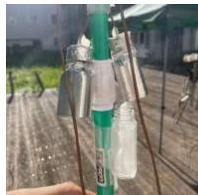
図6 センサー(乾球温度計, 湿球温度計, 放射遮蔽シェルター(φ30mm, H75mm))
